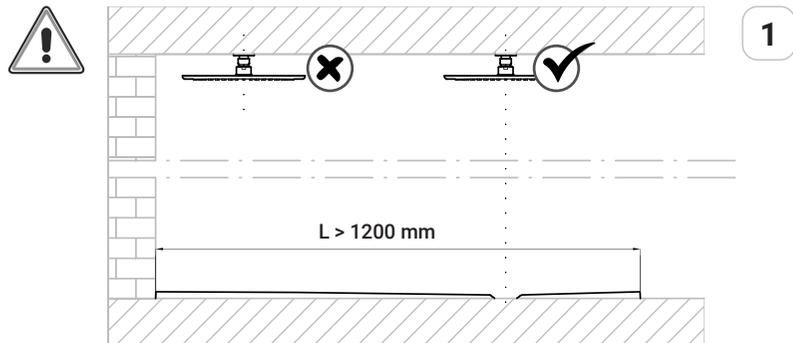
Per  $L > 1200$  mm si consiglia di installare il soffione in prossimità della piletta, per favorire lo scarico dell'acqua.
